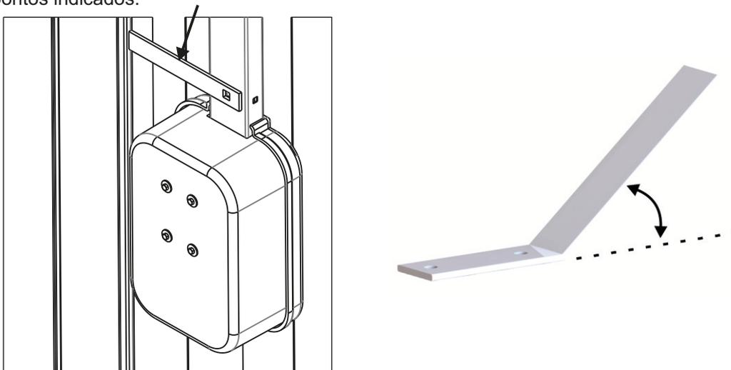
**Figura 5:** Fixar o “Suporte Dobrado” na calha através de parafusos e após fixar com ponto de solda no portão, para reforço de sustentação do movimentador.
