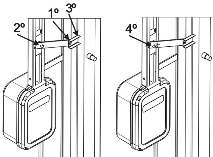
**Figura 6:** 1º Fixar com um pingo de solda o “Cavelete com Pino” no “Braço de Destramento” o “Suporte Dobrado”. 2º Posicionar o “Braço de Destramento” sobre o pino do “Fechamento da corrente”. 3º Com o portão todo fechado, fixar com pingo de solda o “Cavelete com Pino” na parte móvel do portão. 4º colocar o “Espelho do Braço” sobre o “Braço de Destramento” e colocar o pino de “Travamento do espelho do Braço”.
